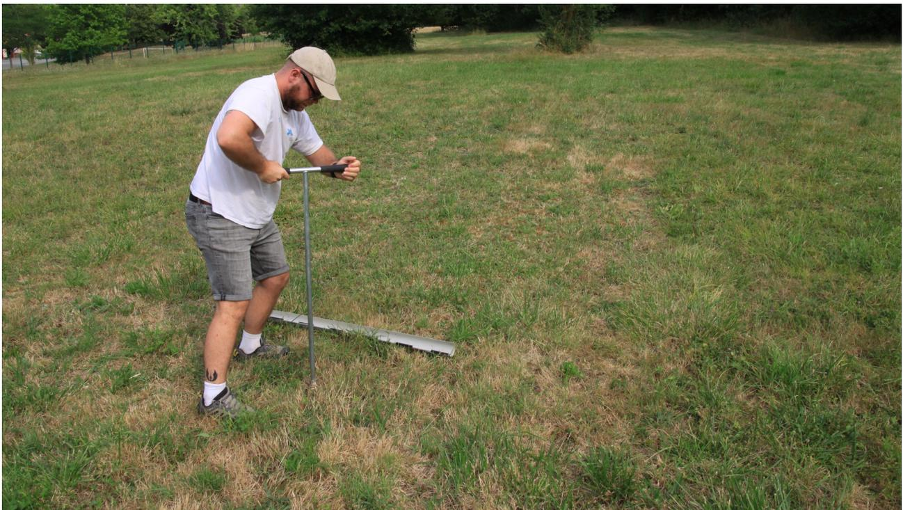
*Figure 2 : Le sondage pédologique a été réalisé à la tarière manuelle hélicoïdale*
